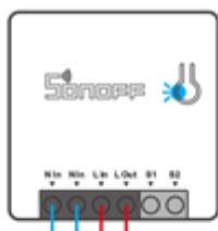
Após ligar o aparelho entrará em modo de pareamento (Touch) durante o primeiro uso. O indicador LED Wi-Fi mudará para um ciclo de dois flashes curtos e um longo.
