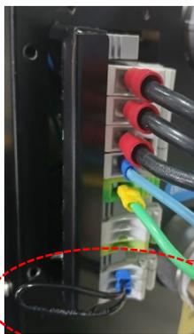
Pino 02 e pino 03 com jumper, função de chave externa operacional. Essa função aciona o aquecedor pela chave externa, o botão liga/desliga da máquina e o Sonoff (funcionamento em conjunto).
